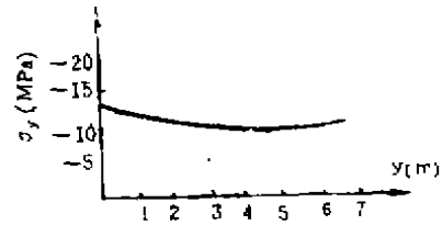
图20 x = \frac{a}{2} 处侧板1上表面应力 \sigma_y 的变化曲线
