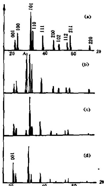
图 1 PT 薄膜 $\text{x}$ 射线衍射谱
