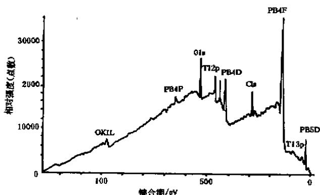
图2 750℃热处理工艺后XPS能谱扫描图
