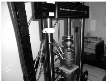
图 2 基于 INSTRON 8874 型高温材料试验机的高温接触热阻试验装置
