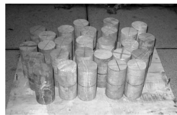
图1 岩溶灰岩试样
