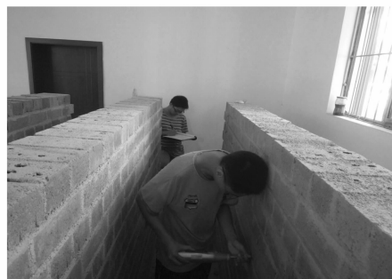
图 7 回弹试验过程 Fig. 7 Rebound testing
